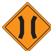
PUENTE ANGOSTO PTF - 2
