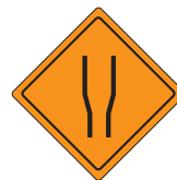
ENSANCHAMIENTO A AMBOS LADOS PTF - 3a
