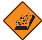
ZONA DE DERRUMBES PTE - 1
